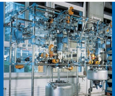
Combination: Pressure reactor with glass overhead Kombination: Druckreaktor mit Glasaufbau
