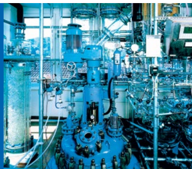
630 liter glass lined steel reactor with glass distillation overhead 630 Liter emailierter Stahlreaktor mit Glas Destillationsaufbau
