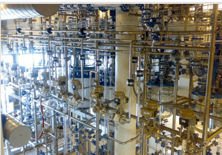
Glass tubing / piping – easy and safe due to flexible glass connection Glas Rohrleitungsbau – einfach und sicher durch flexible Glasverbindung
